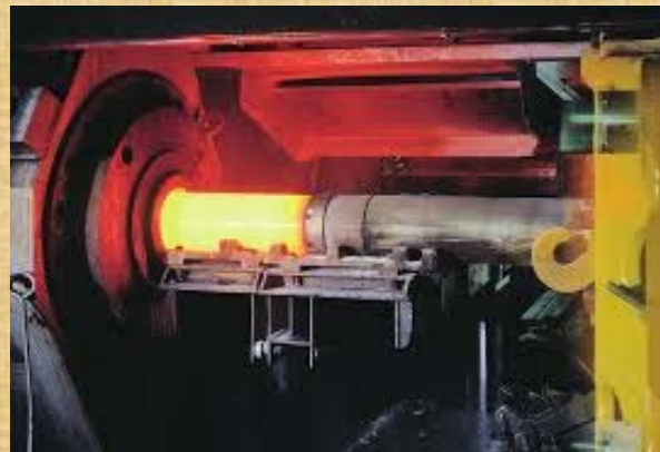
مراحل تولید لوله غلاف زیر کونیم با روش اکستروژن
