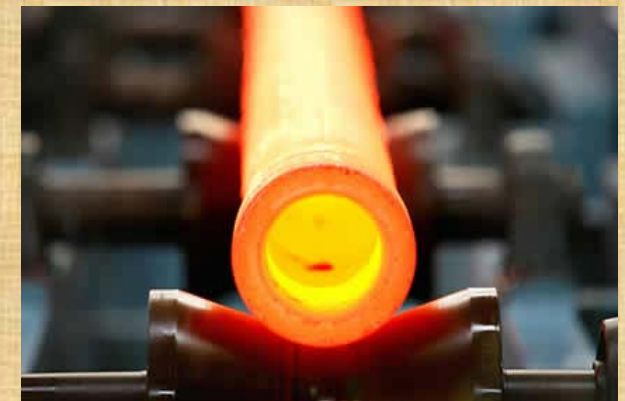
مراحل تولید لوله غلاف زیر کونیم با روش اکستروژن
